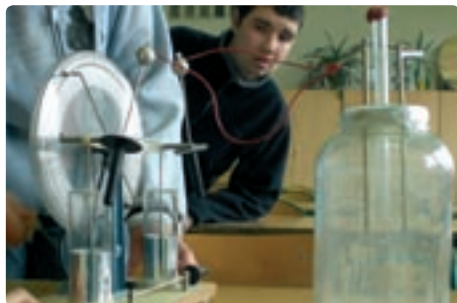
Doświadczenie z modelem filtra elektrostatycznego.
